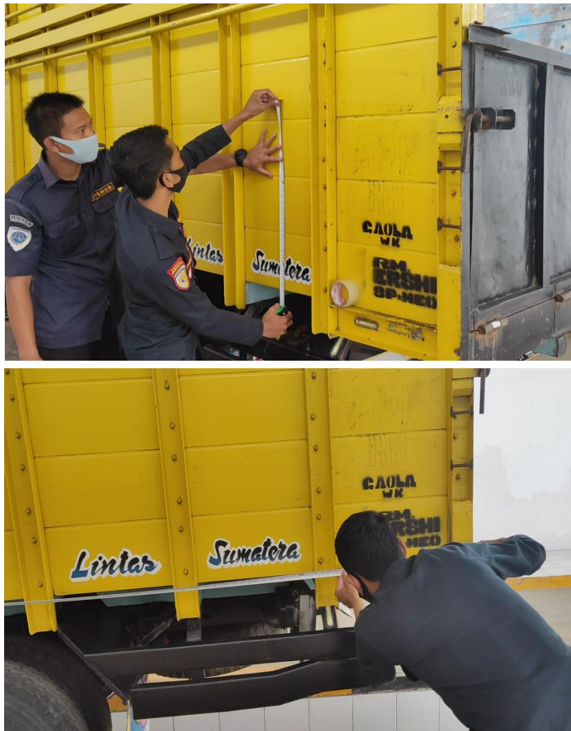
Gambar 7. Melakukan Pengukuran Dimensi Kendaraan Bak Terbuka (Truk)
